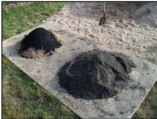
Abbildung 5: Vermischung verschiedener Substratkomponenten für die Lysimeterbefüllung
